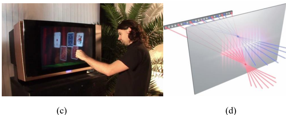
Figura 7. Exemplos de displays 3D: (a) Google Cardboard, (b) Microsoft Hololens, (c) HoloVizio; e (d) esquema de funcionamento um display light field .
